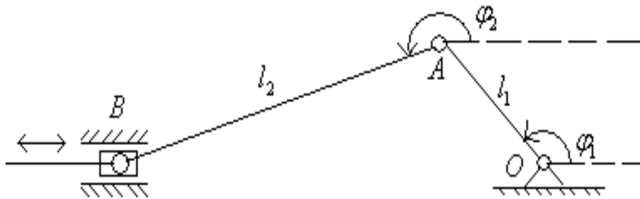
Figure 2 : Schéma du mécanisme bielle-manivelle
