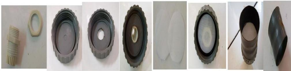
**Figure 2 :** *Matériel utilisé pour la conception du carter de filtration*
