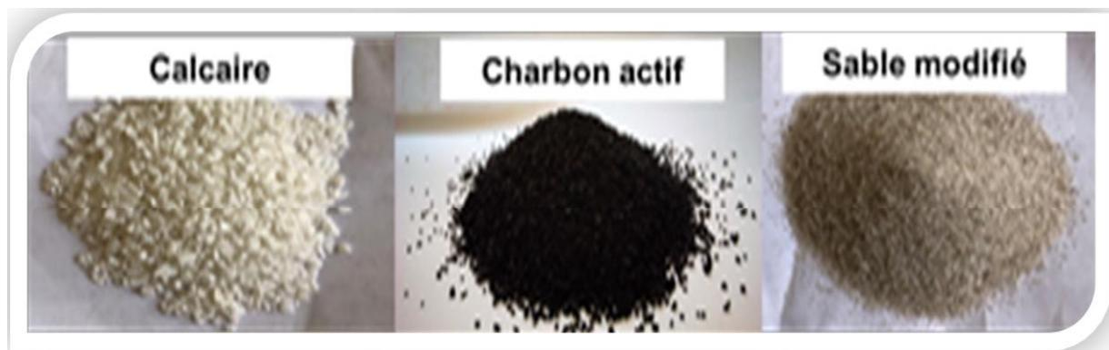
**Figure 3 :** *Matériaux granulaire de filtration*
