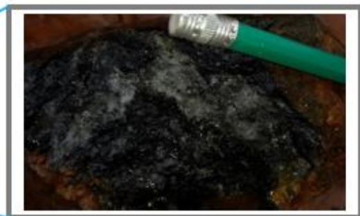
Figure 4 : Portion de l'amphibolite avec des grains de sulfures disséminés Station : 14^{\circ}53'38.4''\text{S} ; 50^{\circ}04'41.7''\text{E}
