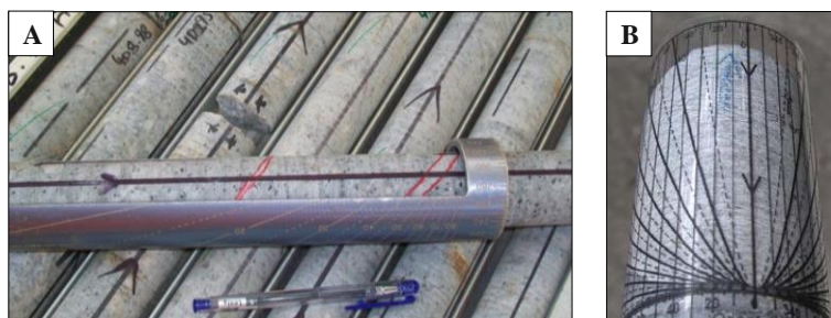
Photo 2 : (A) Photographie d'un kenomètre et (B) celle d'un protractor
