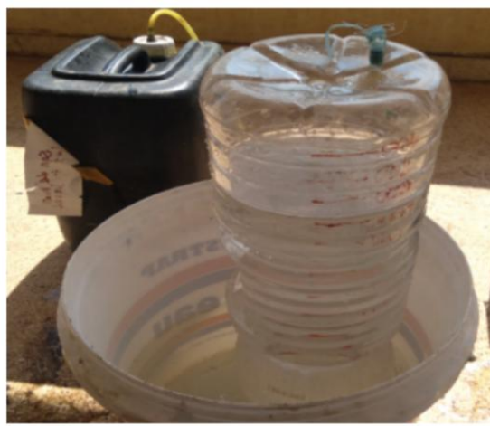
Figure 6 : Test de la présence de biogaz formé
