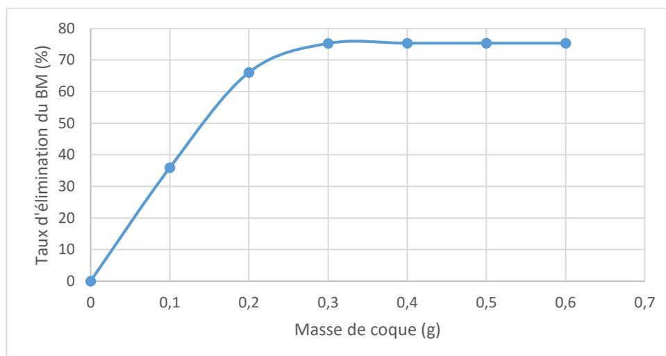
**Figure 3 :** Effet de la masse des coques de neem sur la quantité de BM adsorbée
