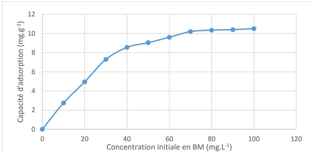
**Figure 4 :** Efficacité de l'adsorption du BM en fonction de la concentration initiale en BM ( $V = 100 \text{ mL}$ ;  $CBM = 50 \text{ mg.L}^{-1}$ ;  $\text{pH} = 6,21$ ;  $T = 25 \text{ }^\circ\text{C}$ ;  $t = 120 \text{ min}$ )
