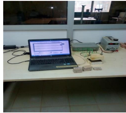
Photo 3 : Dispositif expérimental du plan chaud symétrique
