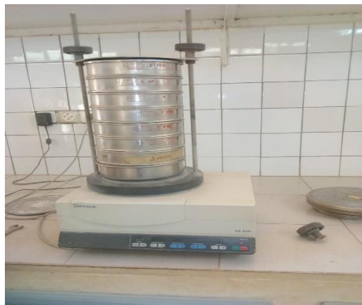
Photo 1 : Dispositif expérimental de la granulométrie par tamisage
