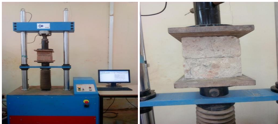
Photo 4 : Dispositif expérimental de l'essai de compression
