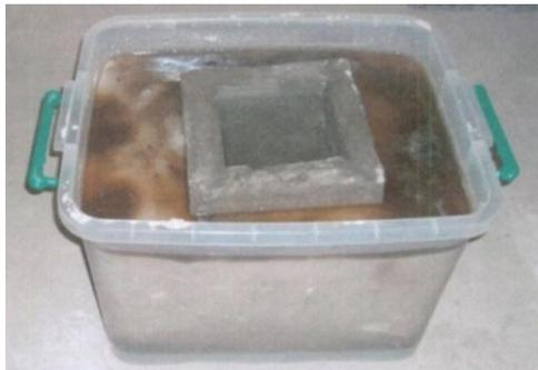
**Figure 1 :** Bac en plastique contenant le polluant (ammoniac) + sable et cuve en béton contenant l'eau potable
