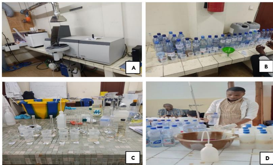
Figure 5 : a) Spectromètre d'absorption atomique ; b) Filtrage d'échantillons à l'aide d'un papier filtre ; c) Préparation des solutions standard avant analyse par la méthode de spectrométrie ; d) Analyse des échantillons d'eaux souterraines par la méthode volumétrique et titrimétriques
