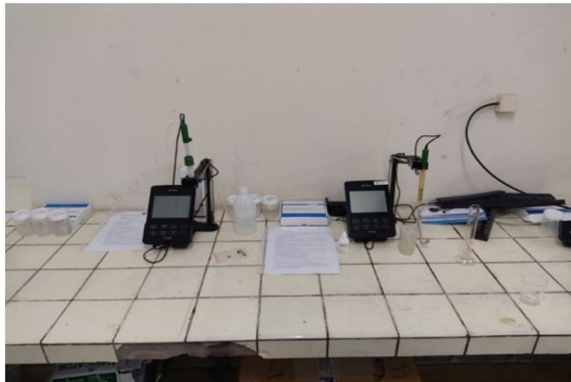
Figure 6 : Multi paramètre HANNA utilisé pour mesurer les paramètres physico-chimiques in-situ
