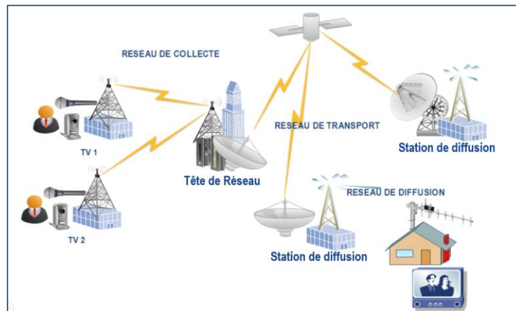
Figure 3 : Architecture de déploiement de la TNT au Bénin
