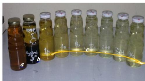
**Figure 2 :** Echantillons d'huile de palmistes brute (a), Séparation des esters naturels du glycérol après réaction de transestérification (b) et échantillons d'EMHP dégazés (c)
