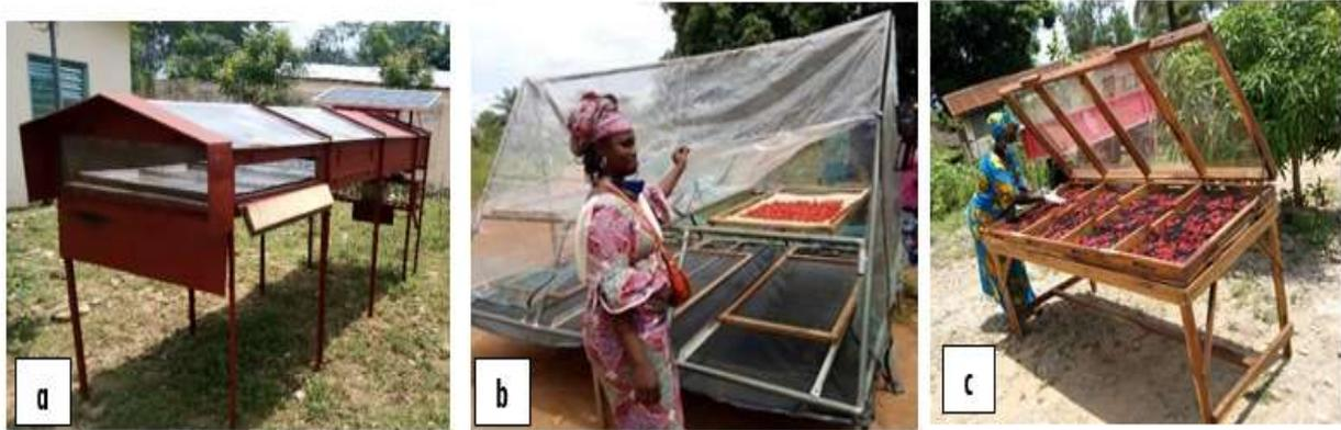
Photo 1 : Image des séchoirs solaires Hybride (a), Tente (b) et Caisse (c)
