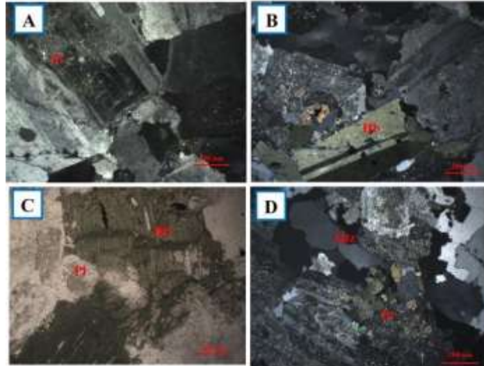
Figure 4 : Aspects microscopiques du PGB (face perpendiculaire à l'étirement minéral) Pl : plagioclase, Qtz : quartz, Hb : hornblende
