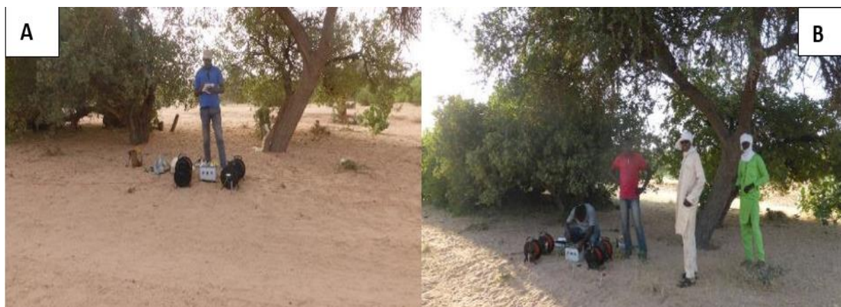
Figure 4 : Réalisation de sondages électriques verticaux avant (A) et après saison de pluie (B) au point 12 dans le bas-fond
