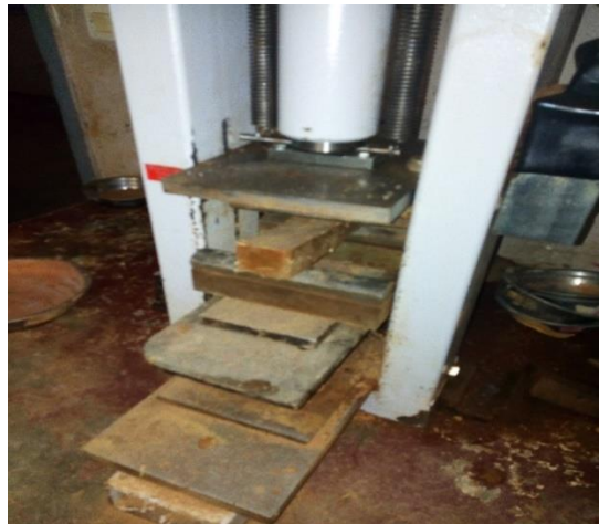
Figure 5 : Essai en flexion 3 points
