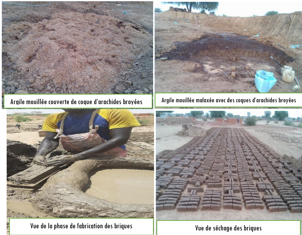
Figure 3 : Vues de quelques étapes illustratives de fabrication des briques en argile
