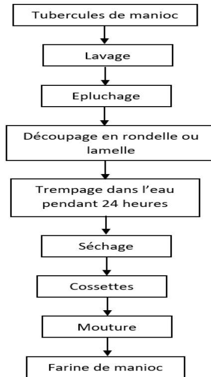
Figure 2 : Diagramme de transformation des tubercules en cossettes / Farine de manioc
