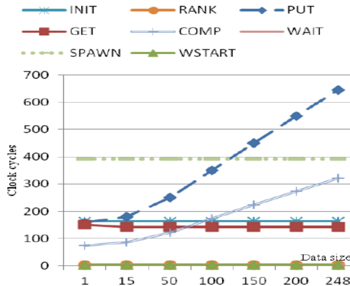
Figure 4 : Latence des primitives du middleware MPI en cycles d'horloge
