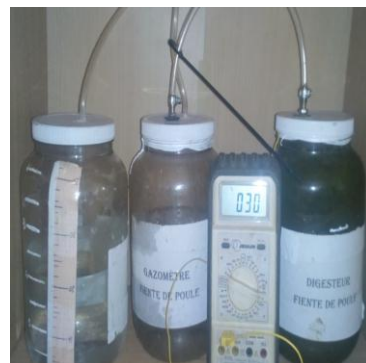
Figure 6 : Méthanisation avec fiente de poule
