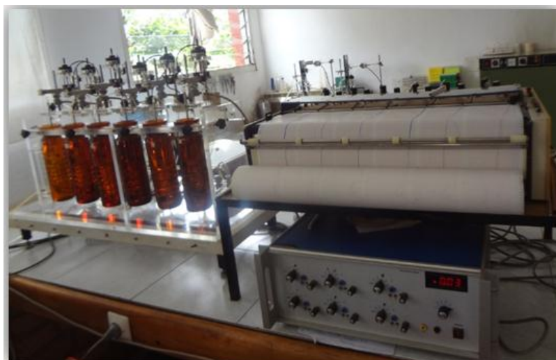
Figure 1 : Appareillage à organe isolé pour la mesure d'activité broncho relaxante
